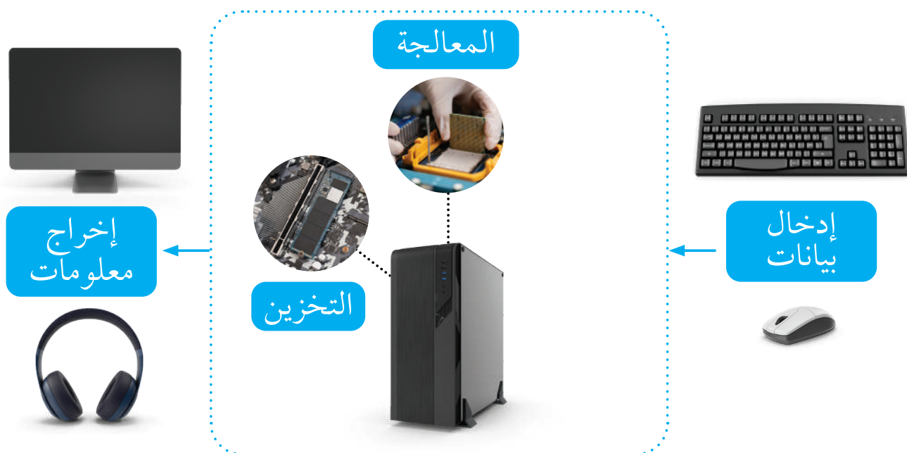
الشكل (1-1): رسم توضيحي لمبدأ عمل جهاز الحاسوب.
